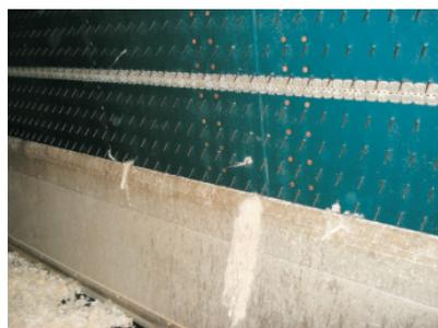
Detalle de la parte posterior de la telera, donde se observa el empalme con grapas.
